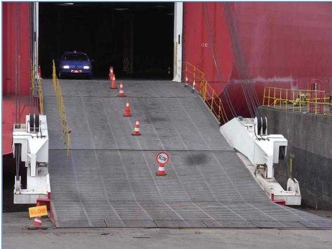
Laderampen möglichst so ausrichten, dass keine Lücken zwischen Kaimauer und Schiff entstehen. Fuß- und Verkehrswege sind getrennt.
